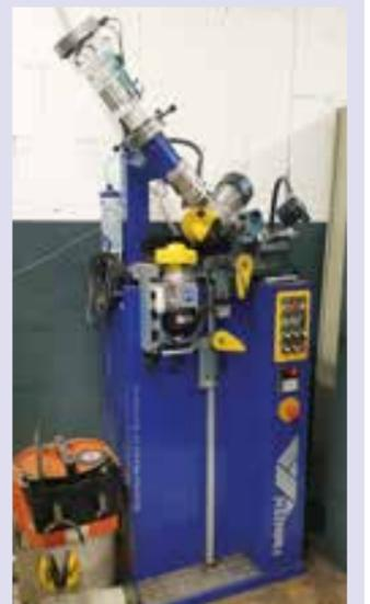
oder Reparatur von Mähergeräten, Strauch- oder Heckenschere: Die Profis in Fröndenberg helfen Ihnen gerne weiter. Die Werkstatt verfügt unter anderem über einen Sägekettenautomaat mit Kühleinrichtung zur Kettenschonung, danach ist Ihre Kette wieder wie neu.
