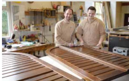
Bei einem Orts-termin zeigte sich, dass die alten Läden stark verwittert waren und an vielen Stellen bereits Wasser in die Konstruktion eingedrungen war. Auch die Verbindung zu den Drehbeschlägen verfaulte teilweise, dadurch hingen einzelne Flügel schief oder ließen sich kaum noch öffnen und schließen. In solchen Fällen werden dann viel zu oft die Läden aus Kunststoff oder Aluminium ersetzt, was aber leider der Architektur die originale Anmutung komplett nimmt.
